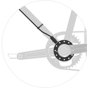
ペダルセンサーケーブルは、自転車のダウンチューブ下側に安全に固定します。
