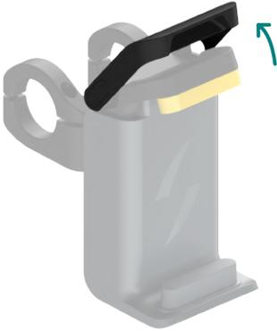
1.2 Coloque la parte inferior de la batería en el bloque de alineación de la montura.
