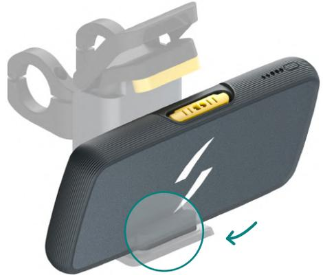
1.3 Después, incline la batería para alinear los dos conectores amarillos.
