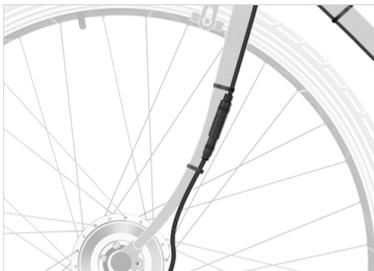
Fije el cable del motor a la horquilla de la bicicleta.
